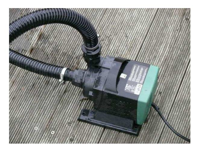
Hier sieht man ein Pumpenmodell ähnlicher Bauart, jedoch von einem anderen Hersteller. Der Anschluss der Schläuche ist aber genau gleich, dem unserer Skimmerpumpe. Am seitlichen Anschluss wird über den Skimmerkorb angesaugt und nach oben weg wird das Schmutzwasser dann in den Filter transportiert. Ebenfalls sinnvoll ist der Einbau der T-Stück Lösung aus unserer Filterbauanleitung. Das ist deshalb sinnvoll um den Rücksog abreissen zu lassen, wenn Sie die Pumpe ausschalten.
