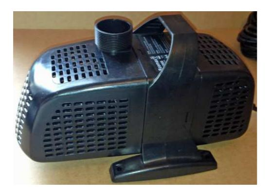
Diese spezielle Bauweise der *Teichpumpe ist am besten für Skimmer geeignet*. Sicherlich kann man diese auch für Teichfilter, Bachlauf und Wasserfall verwenden, aber der Einsatz am Skimmer hat hier Vorrang. Der Grund ist der Gewindestutzen an der Saugseite der Pumpe. Man kann den Gehäusedeckel bequem abziehen und an der Saugseite eine Schlauchtülle für den Skimmertopf aufschrauben. Die Pumpe ist sehr preisgünstig, erfüllt aber trotzdem zuverlässig ihren Zweck.
