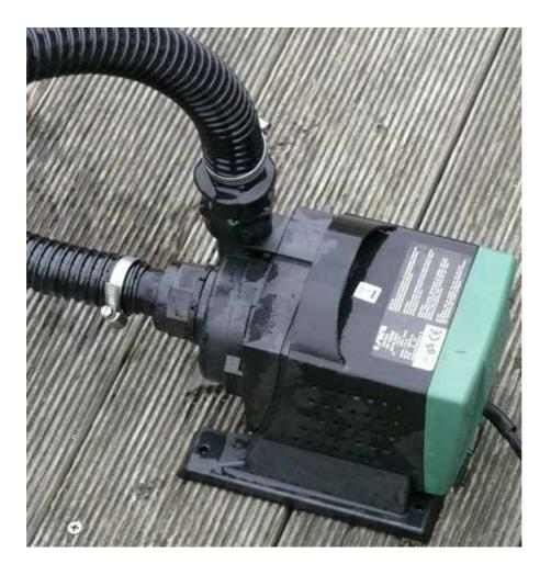
So schließen Sie den Saugschlauch und den Pumpenschlauch an die Tüllen der Pumpe für Skimmer an. Den Gehäusedeckel brauchen Sie in diesem Fall gar nicht. Die Pumpe liegt im Betrieb im Teich unter Wasser. *Sichern Sie die Schläuche mit Schlauchschellen*. Die Durchmesser der <u>Schläuche sind in diesem Fall 32mm und 40mm</u>. Je nachdem wie groß die Schlauchtüllen an der Skimmerpumpe sind.
