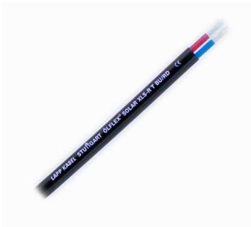
Dieses Kabel verwenden wir für den Anschluss der Solarmodule an den Laderegler. Auch für den Anschluss der Solarkoffer bei der mobilen Solaranlage ist es sehr praktisch weil beide Adern zusammenhängen und nicht Plus und Minus einzeln herumfleddern. Wir verwenden diesen Querschnitt mit 2x2,5mm<sup>2</sup> für unsere Module bis 150W und mit bis zu
