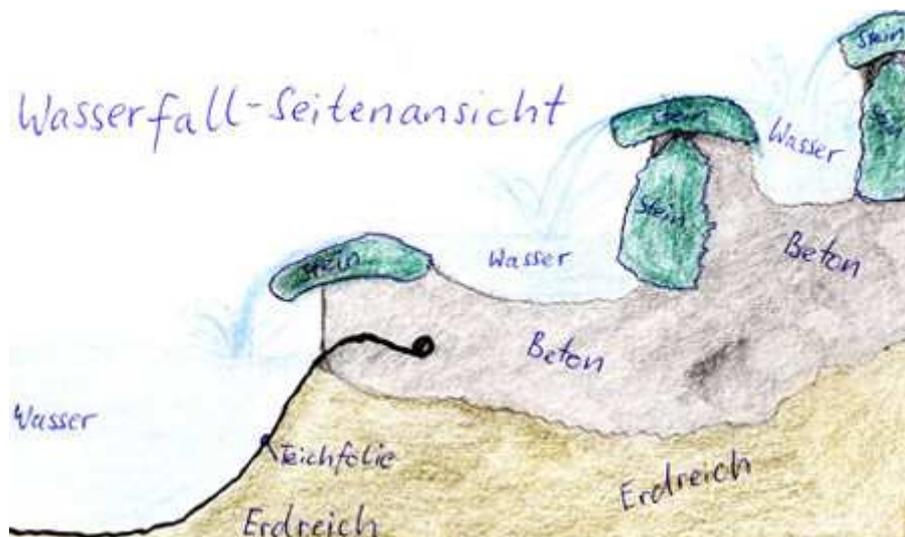
In dieser Skizze sehen Sie wie man die Feldsteine am günstigsten anordnet. Am Boden der Staustufen brauchen keine Feldsteine einbetoniert werden. Sie sehen auch wie die Teichfolie und die Ufermatte zum Teil in die erste Staustufe mit einbetoniert wurden.
