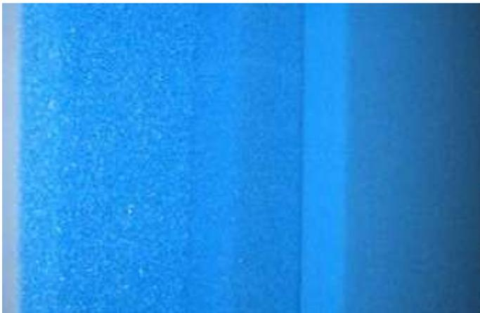
Hier erkennen Sie die 3 verschiedenen Porengrößen von *PPI10*, *PPI20* und *PPI30*. PPI10 verwenden wir für Filtermatten als grobe Filterstufe in den ersten Regentonnen. PPI30 wird dann für die feine Filterstufe genutzt. Also in den letzten Tonnen damit auch feinste Partikel effektiv im Filter bleiben. PPI20, also mittelgrob wird bei unseren [Filtersets](#) ausschließlich für Filterwürfel verwendet. Sollten Sie jedoch eine ganze Filtermatte in
