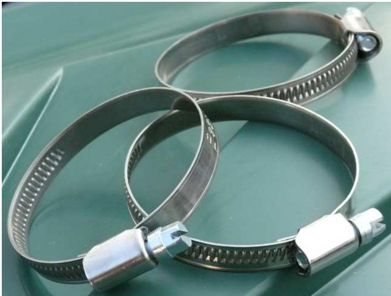
Die Schlauchschellen mit Edelstahlband halten den Spiralschlauch sicher an den Anschlüssen. Die Schellen sind sehr hochwertig, weil die Rillen am **Band nicht nur gestanzt sind wie bei der minderwertigen, amerikanischen Ausführung** sondern aufgebördelt. Somit kann das Gewinde auch bei stärkerem Drehmoment standhalten. Die Schlauchschellen finden Sie wie alles andere hier bei uns im Shopbereich.
